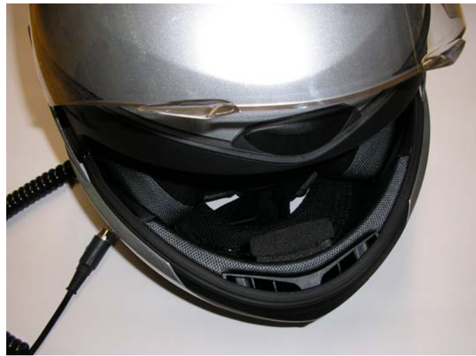
Mikrofon unterpolstert bei großem Abstand zum Mund
