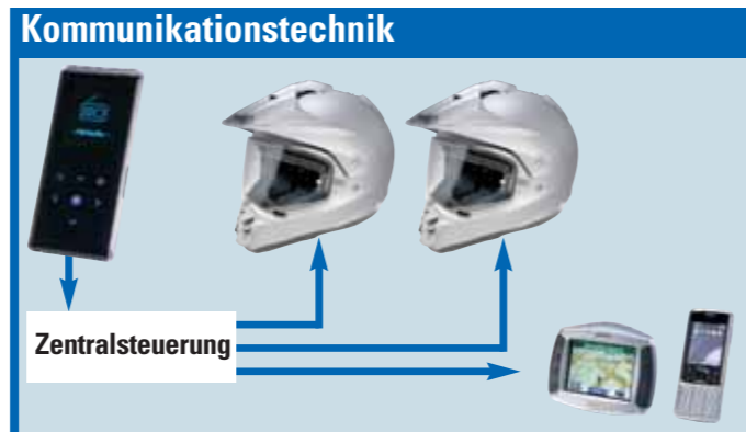
Um viele unterschiedliche Geräte gleichzeitig zu betreiben, muss die Steuereinheit nicht nur unterschiedliche Eingangssignale verarbeiten, sondern sie auch in einer definierten Reihenfolge zu- und abschalten.
